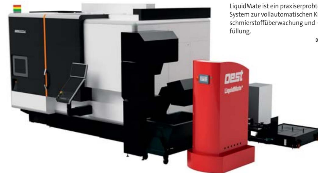
LiquidMate ist ein praxiserprobtes System zur vollautomatischen Kühlschmierstoffüberwachung und -nachfüllung.
